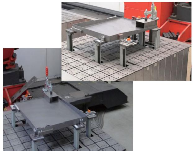
図7 ジグロボットの例 昇降治具とアタッチメントを使用した固定方法。
