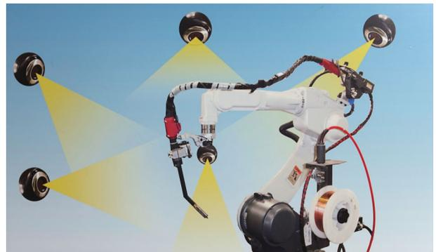
図6 ロボットシステムのトレーサビリティ ロボットの作業履歴が画像で毎秒記録可能。複数台のカメラが、ヒューマンエラーや予測不可能な不具合を見守り記録するため、加工品質及び顧客からの信頼度が向上する。
